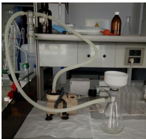
Figura 10. Equipo empleado para la filtración, compuesto por la bomba de succión, el kitasato y el embudo de porcelana.
