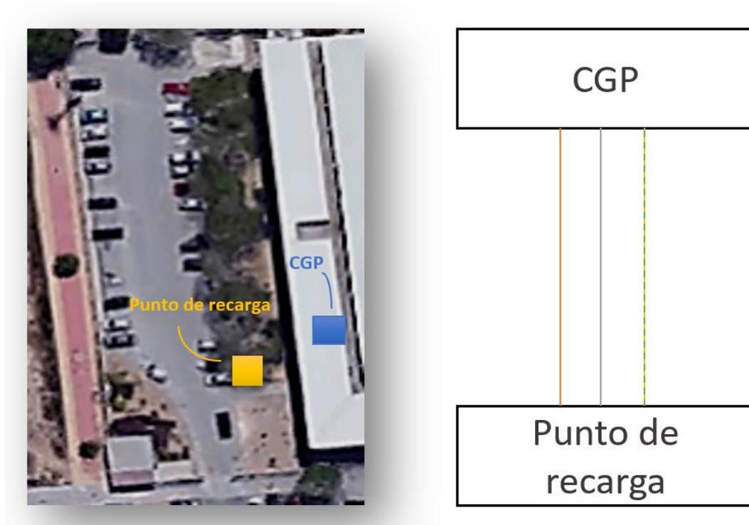
Ilustración 6.4. Esquema punto de recarga.
