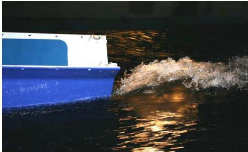
Figura 58. Elevación de ola en popa a  $3.96\text{m/s}$  y desplazamiento de diseño.
