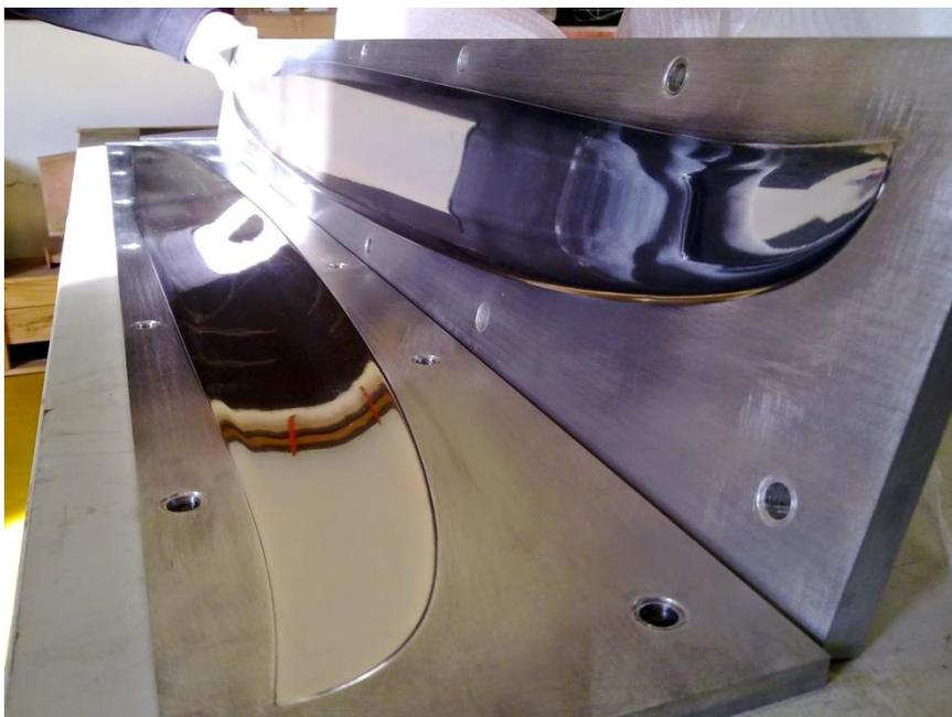
Figura 68. Moldes hembra y macho para la fabricación de apéndices [24].
