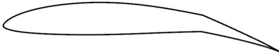
Figura 37. Sección Eppler 393 con  $12^\circ$  de ángulo de flap.
