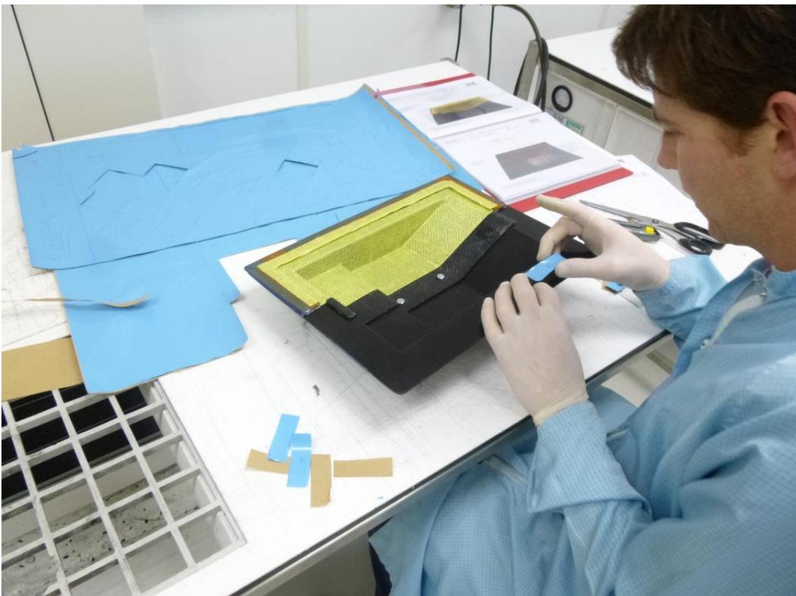
Figura 70. Laminado con prepreg sobre molde hembra [25].
