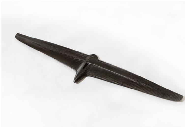
Figura 45. Ejemplo de engrosamiento en foil para orza de Match v2.3.
