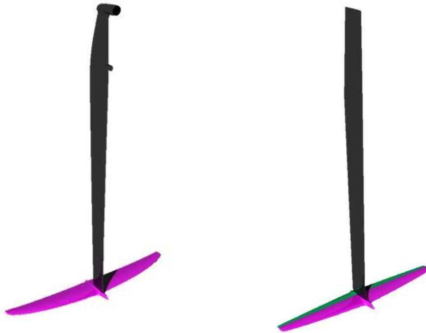
**Figura 46. Renderizado de los modelos 3D de timón (izquierda) y orza (derecha) al completo**
