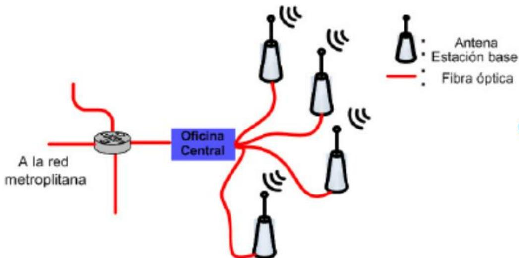
**Figura 1.** Esquema general de un sistema de RoF
