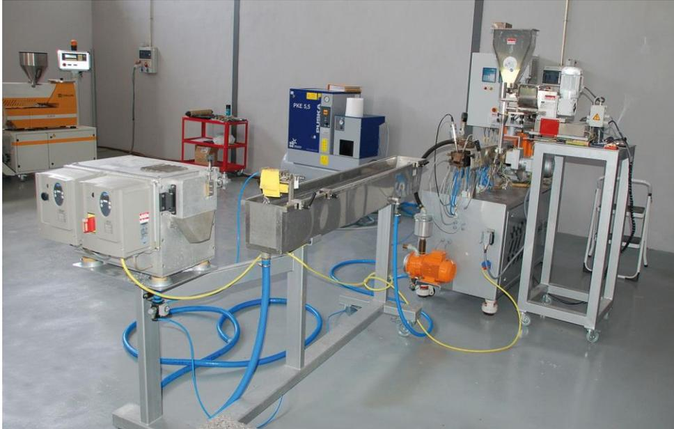
*Figura 3.29 Extrusora Leistrizt ZSE 18HP de doble tornillo corrotante*
