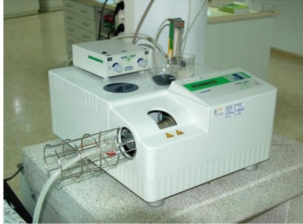
*Figura 3.20 Equipo de análisis termogravimétrico*
