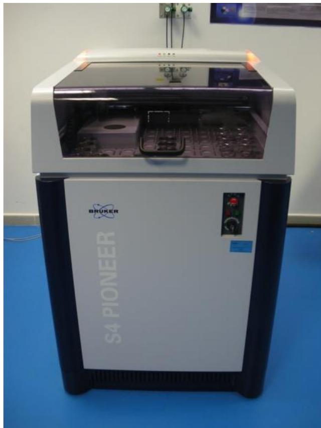
*Figura 3.21 Espectrómetro de fluorescencia de rayos X*
