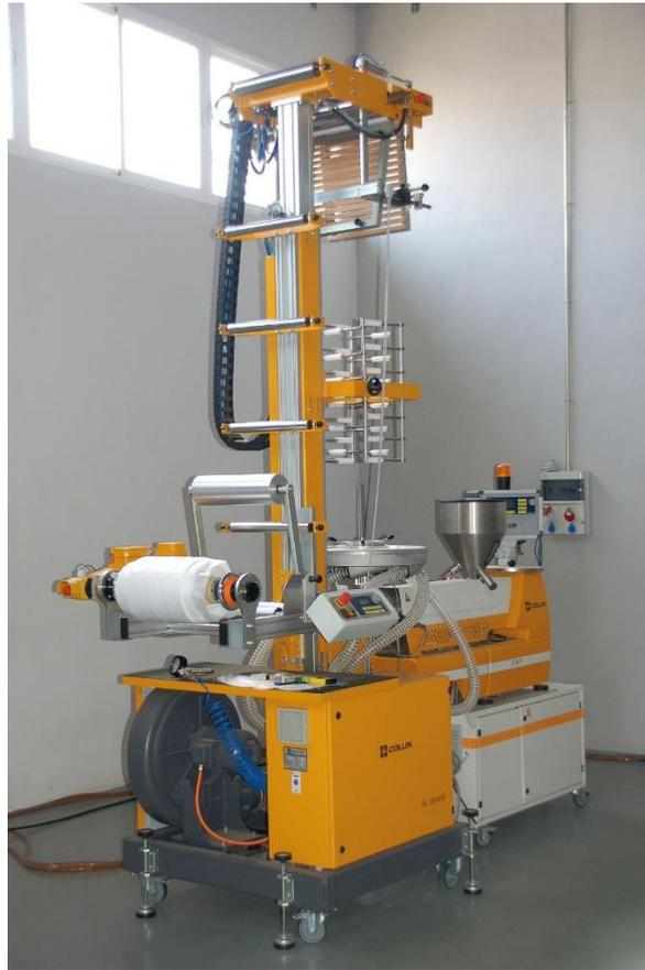
*Figura 3.30 Máquina extrusora de filmes por soplado*
