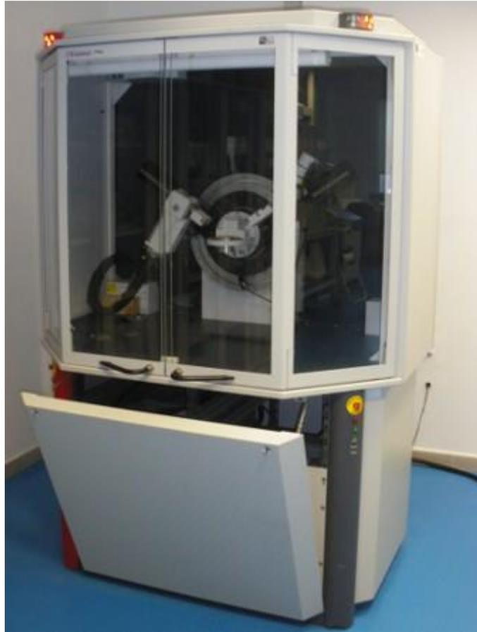
*Figura 3.24 Difractómetro de rayos X de Polvo Bruker D8 advance*
