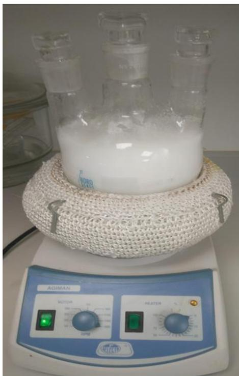
Figura 4.5 Mezcla en continua agitación de la hidrotalcita y el surfactante en un matraz de fondo redondo con 3 bocas.
