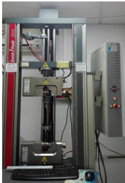
Figura 3.27 Máquina de ensayos de tracción Zwick Roell Z010
