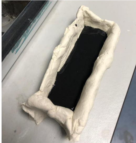
Figura 17. Pasta sobre material de soporte y molde antes de introducirse en el horno.
