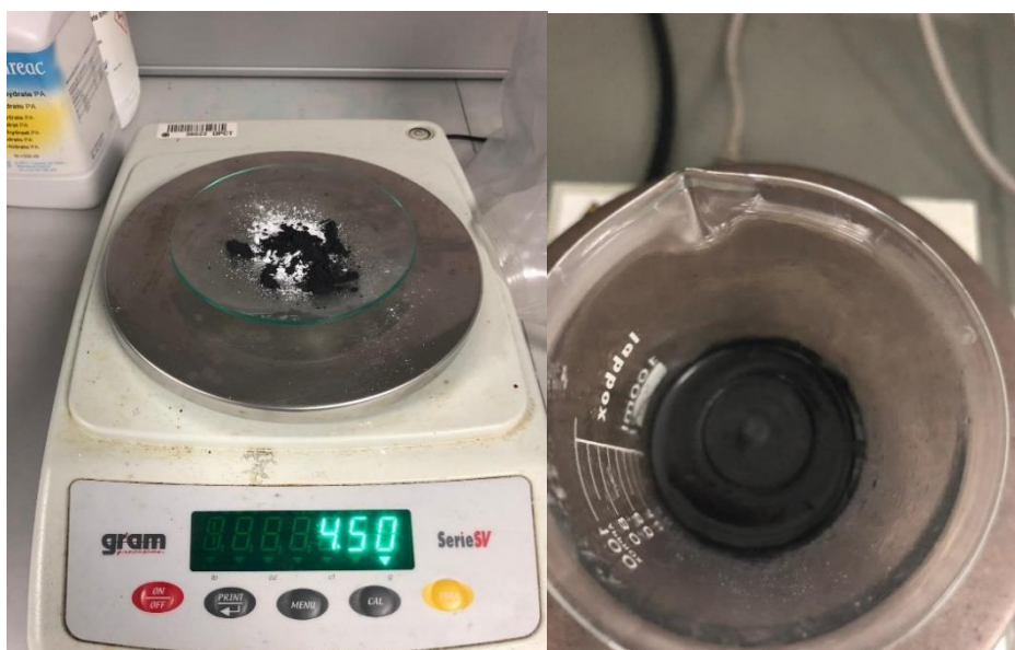
Figura 16. Mezcla grafito y AgCl y disolución con polímero.
