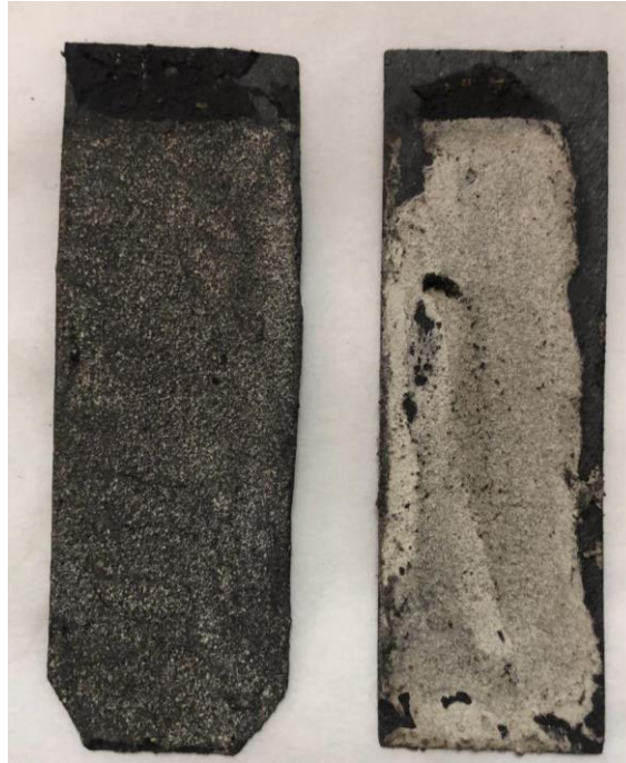
Figura 19. Electrodo con 10 y 30% de grafito descargados un 30% de cloruros de la pasta.
