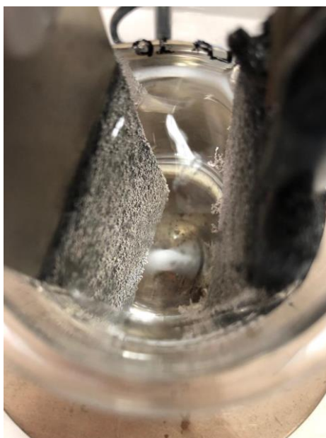
Figura 20. Filtro recubierto de Ag frente a titanio.
