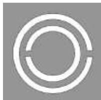
**Figura 1.5.** Representación de un CSRR (metal en la parte gris).
