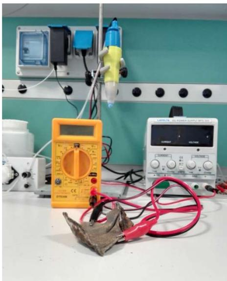
**Figura 3.** Conexiones eléctricas para el tratamiento catódico
