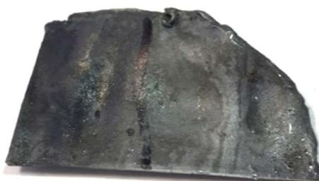
**Figura 4.41.** Chapa de plomo electrolizada parcialmente con NaNO<sub>3</sub> y electrodo de Ag
