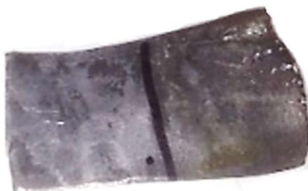
**Figura 4.41.** Chapa de plomo electrolizada parcialmente con  $\text{Na}_2\text{SO}_4$  y electrodo de Ag
