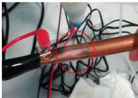
**Figura 4.26.** Electrólisis localizada sobre una tubería de cobre
