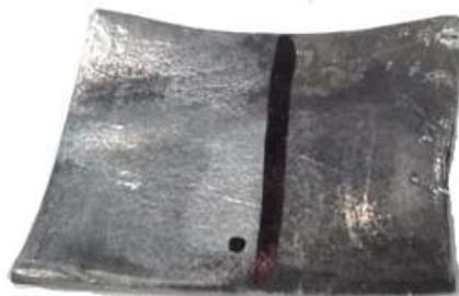
**Figura 4.35.** Chapa de plomo electrolizada parcialmente con  $\text{Na}_2\text{SO}_4$  y electrodo de Pt
