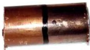
**Figura 4.30.** Tubería de cobre electrolizada parcialmente con  $\text{NaNO}_3$  y electrodo de Pt
