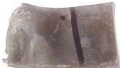
**Figura 4.37.** Chapa de plomo electrolizada parcialmente con  $\text{NaNO}_3$  y electrodo de Au
