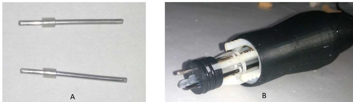
**Figura 4.13** A: topos de silicona insertados en los electrodos; B: lápiz con la carcasa diseñada por SEDIC, UPCT
