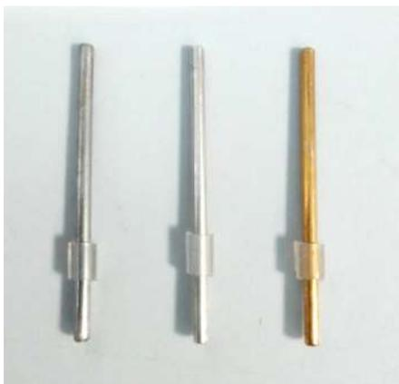
**Figura 3.4.** Contra-electrodos de Pt, Ag y Au
