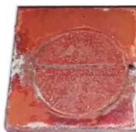
Figura 4.27. Placa de cobre corroída por vapores de HCl
