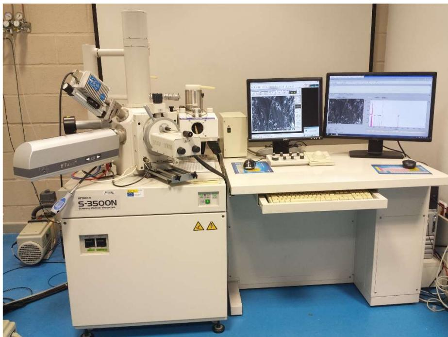
**Figura 3.6.** Microscopio electrónico de barrido S-3500N de Hitachi
