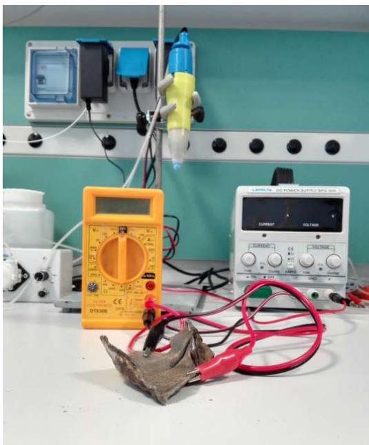
**Figura 4.19.** Conexiones eléctricas para el tratamiento catódico
