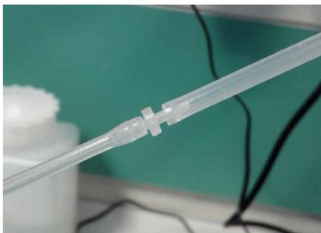
**Figura 4.17.** Colocación de un filtro de cápsula entre dos mangueras de silicona
