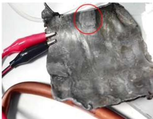
**Figura 4.32.** Electrólisis localizada sobre una chapa de plomo
