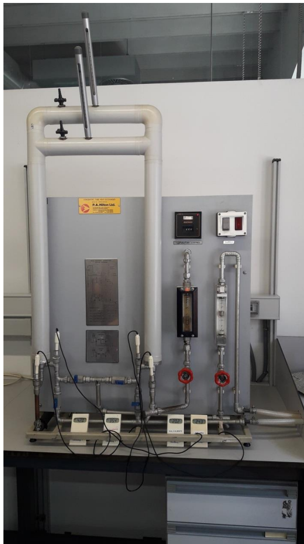
Figura 1.1 - Intercambiador de calor
