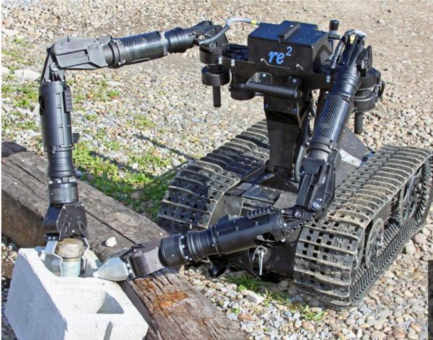
**Figura 1.3 Brazo robótico, antiexplosivos.**
