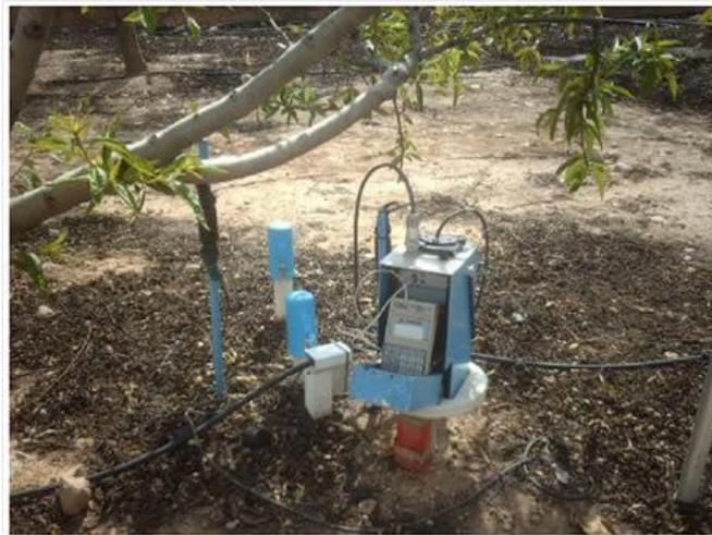
**Figura 2: Sonda de neutrones utilizada para medir la humedad del suelo.**
