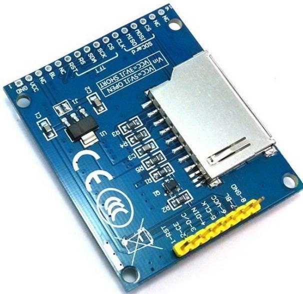
**Figura 23: Vista inferior del módulo TFT 1.8 + Lector SD**
