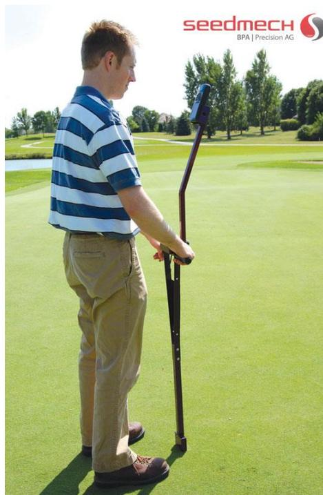
**Figura 3: Sensor TDR 300 Seedmech con GPS.**
