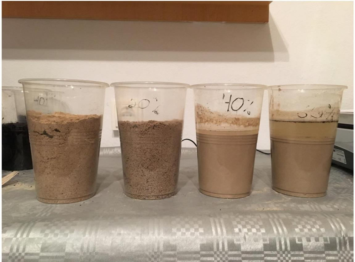
**Figura 37: Muestras utilizadas para la calibración del sensor. A la izquierda con humedad 0% y a la derecha con humedad 60%.**
