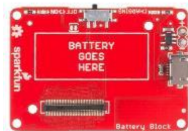
Figura 41 - Bloque de batería
