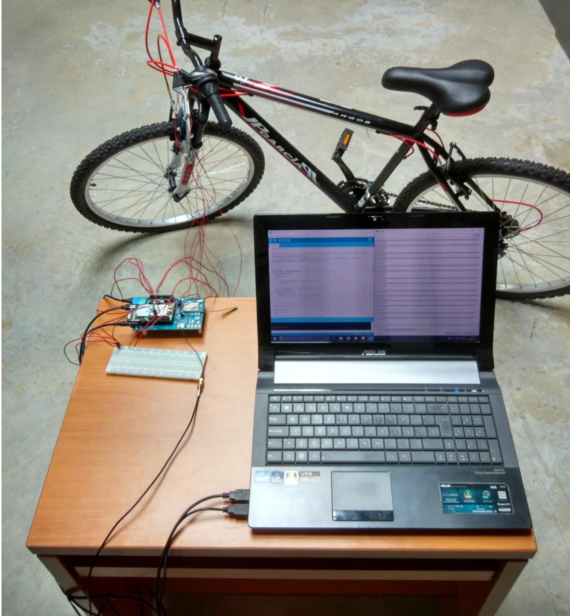
Figura 56 - Prototipo completo para pruebas en laboratorio
