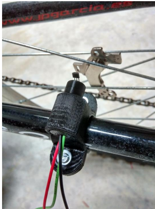
Figura 55 - Soporte y sensor de efecto Hall colocados en bicicleta de pruebas
