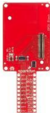
Figura 42 - Bloque de GPIO
