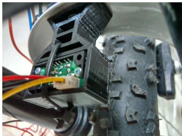
Figura 53 - Soporte y potenciómetro óptico colocados en bicicleta de pruebas
