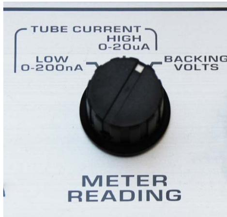
Figura 15: Conmutador rotatorio "Meter Reading". Fuente: Elaboración Propia.
