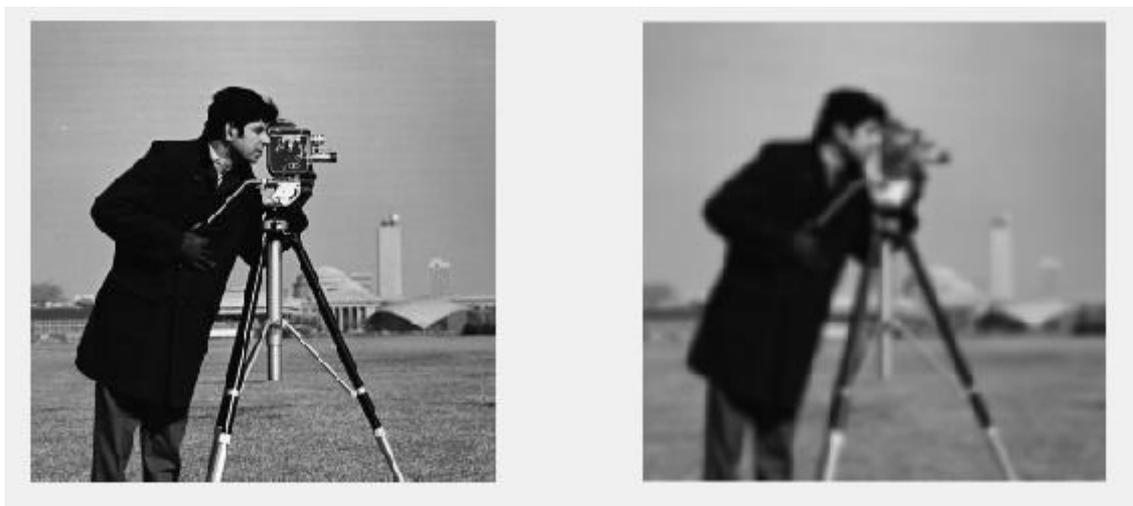
*Figura 15: Ejemplo de la aplicación de un filtro gaussiano a una imagen para su suavizado.*
