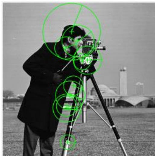
*Figura 10: Ejemplo de algoritmo SURF, que detecta y extrae puntos de interés de una imagen.*
