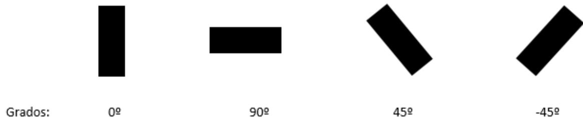
*Figura 39: Orientación de objetos desde el punto de vista del sistema del brazo robótico.*
