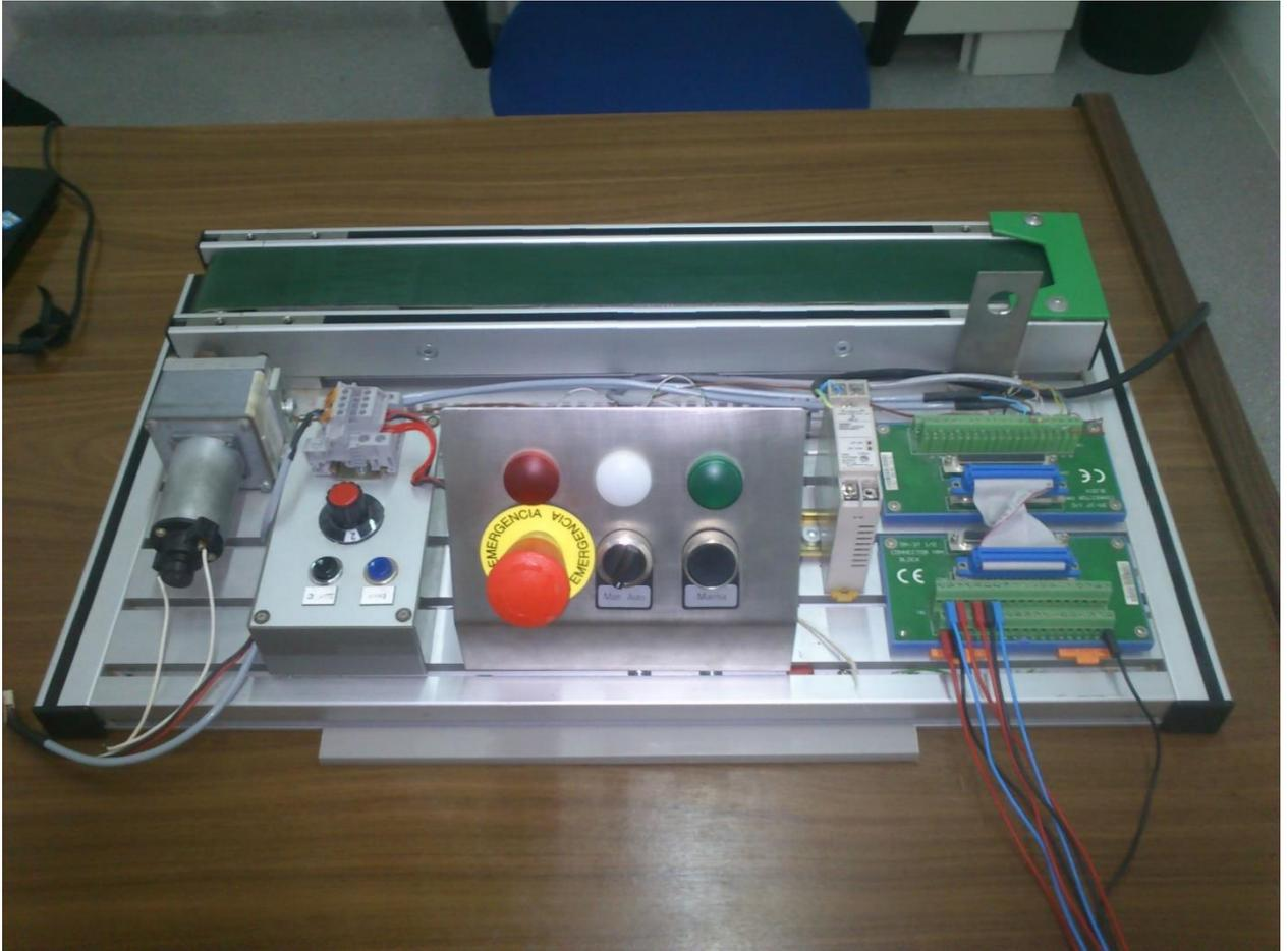
*Figura 1: Maqueta de prácticas con cinta transportadora (arriba), panel de control (centro), motor DC (izquierda) y bornera eléctrica (derecha).*
