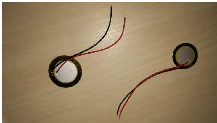
Imagen 59. Fotografía de los dos tipos de piezoeléctricos usados
