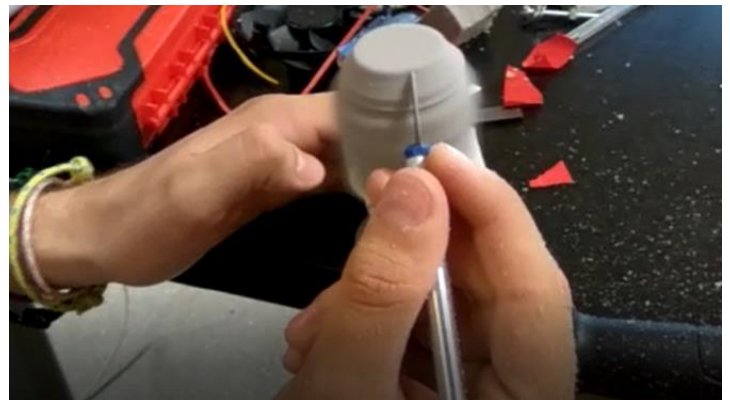
Imagen 89 y 90. Detalle del montaje del taladro y captura de cómo se da forma a la gomaespuma
