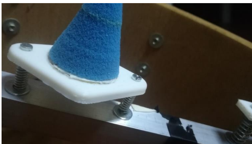
Imagen 117. Detalle del sistema de ajuste por muelles
