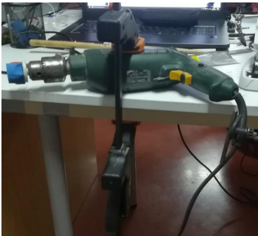
Imagen 89 y 90. Detalle del montaje del taladro y captura de cómo se da forma a la gomaespuma
