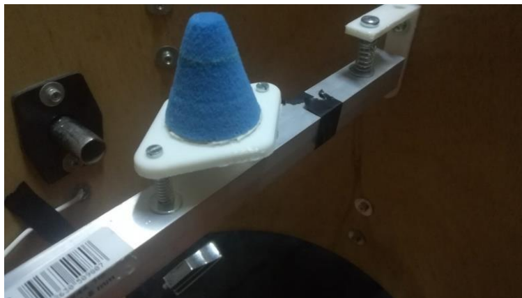
Imagen 61. Estructura donde se montó el sensor piezoeléctrico
