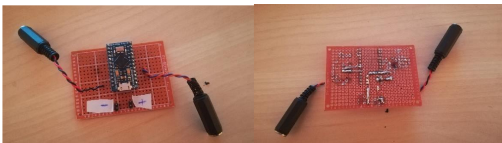
Imágenes 110 y 111. Fotografías del prototipo de la base del Arduino Pro Micro
