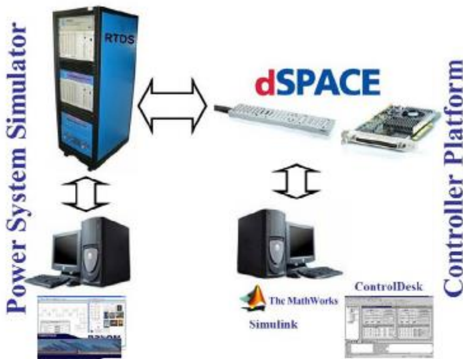
Fig. 5.2. Plataforma de trabajo HIL con controlador real y sistema de la planta simulado en dSPACE.
