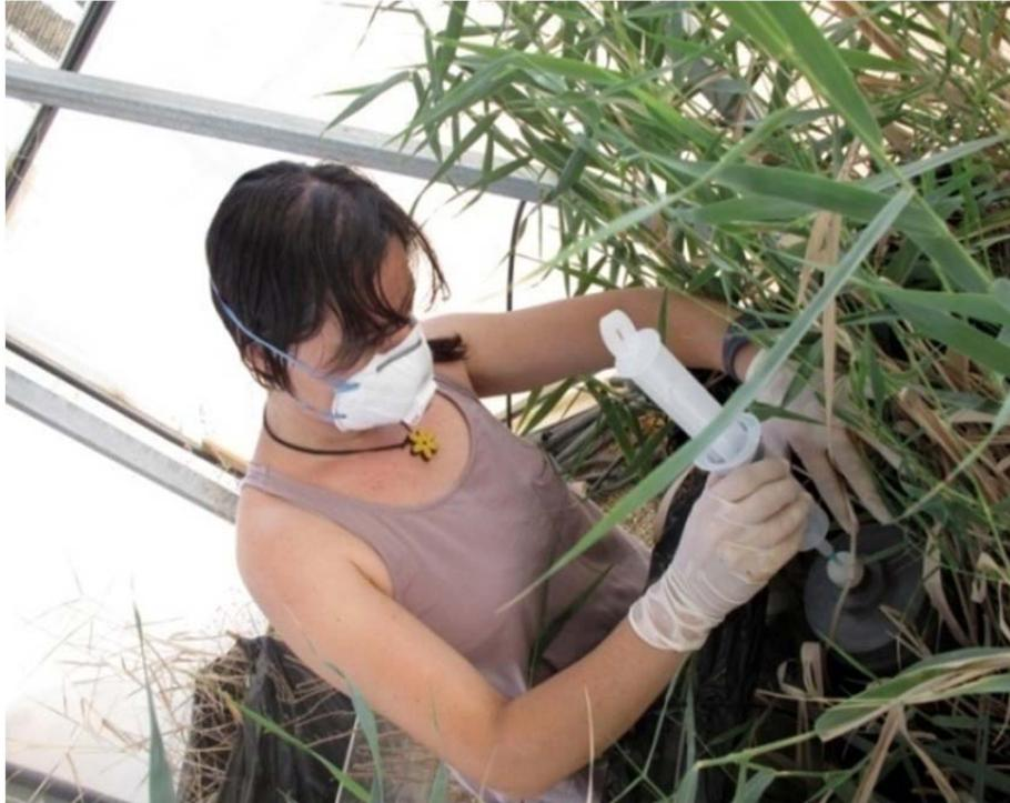
Fotografía 4.13. Introducción del acetileno ( $C_2H_2$ ) con una jeringa a través del septum de goma en una de las cámaras.
