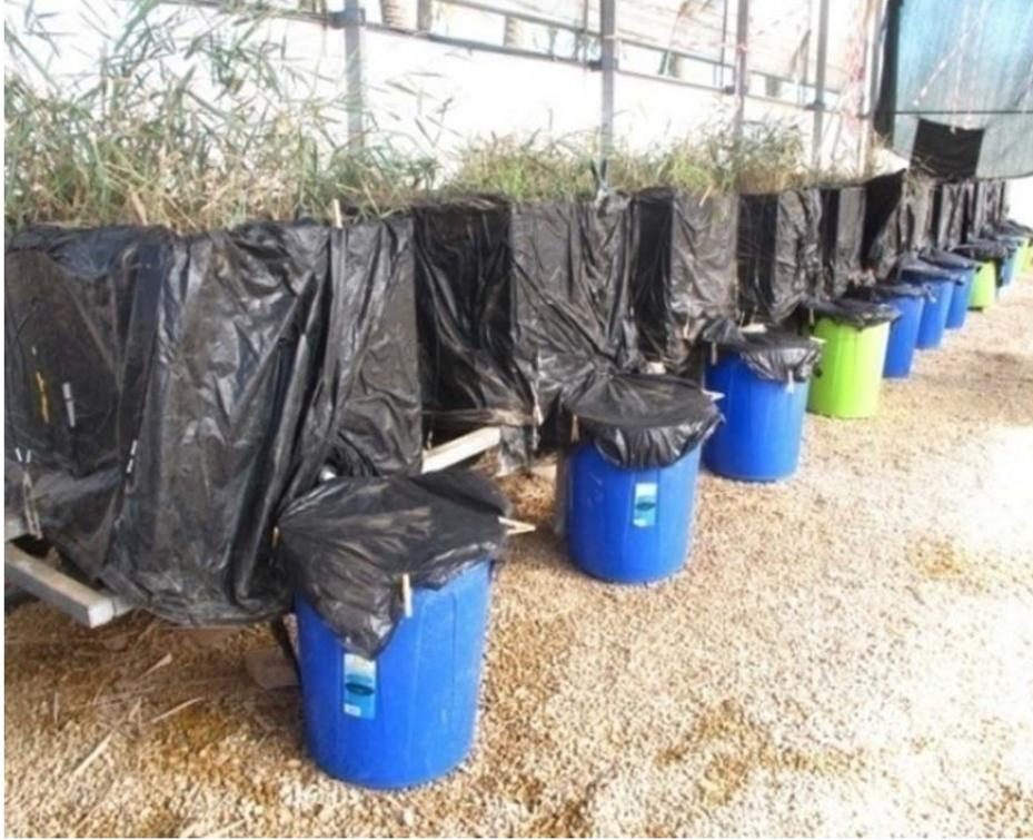
Fotografía 4.11. Contenedores recogiendo los drenajes de los mesocosmos y tapados con un plástico opaco para impedir pérdidas por evaporación y/o deterioro de las muestras.
