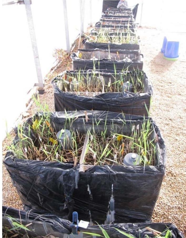
Fotografía 4.5. Detalle de las fundas de plástico opacas para cubrir los depósitos una vez preparados los mesocosmos.
