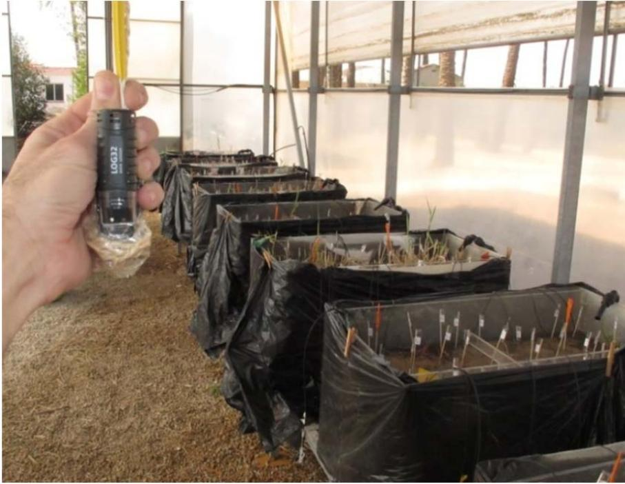
Fotografía 4.8. Datalogger LOG32 utilizado para medir la temperatura y humedad en el interior del invernadero.
