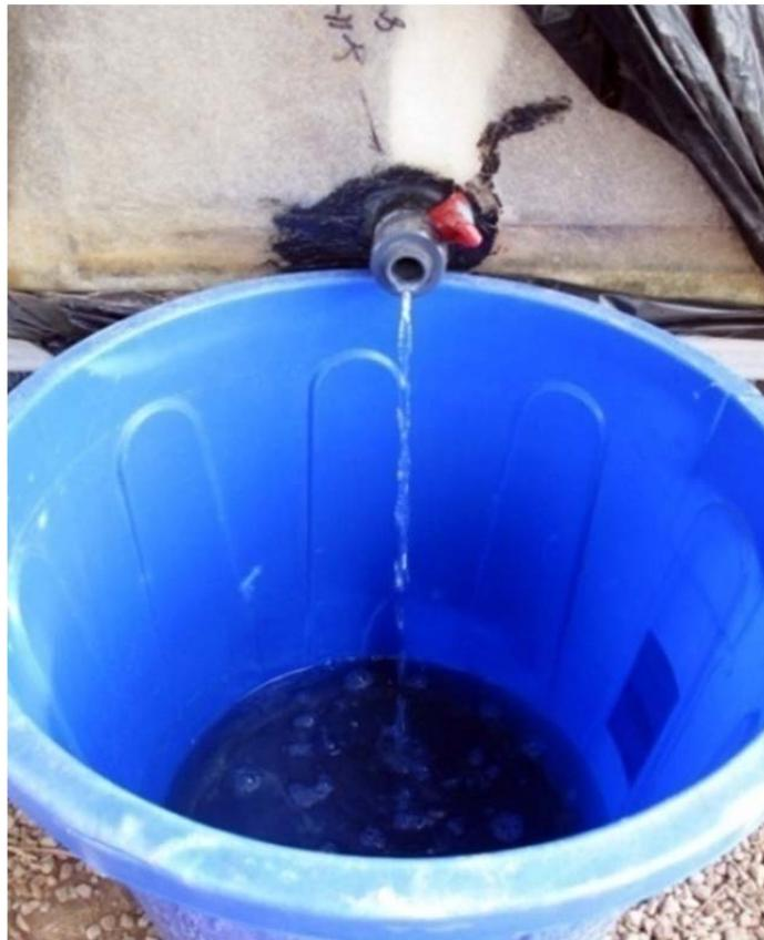
Fotografía 4.10. Contenedor de recogida. Detalle de uno de los grifos para el drenaje de los mesocosmos.
