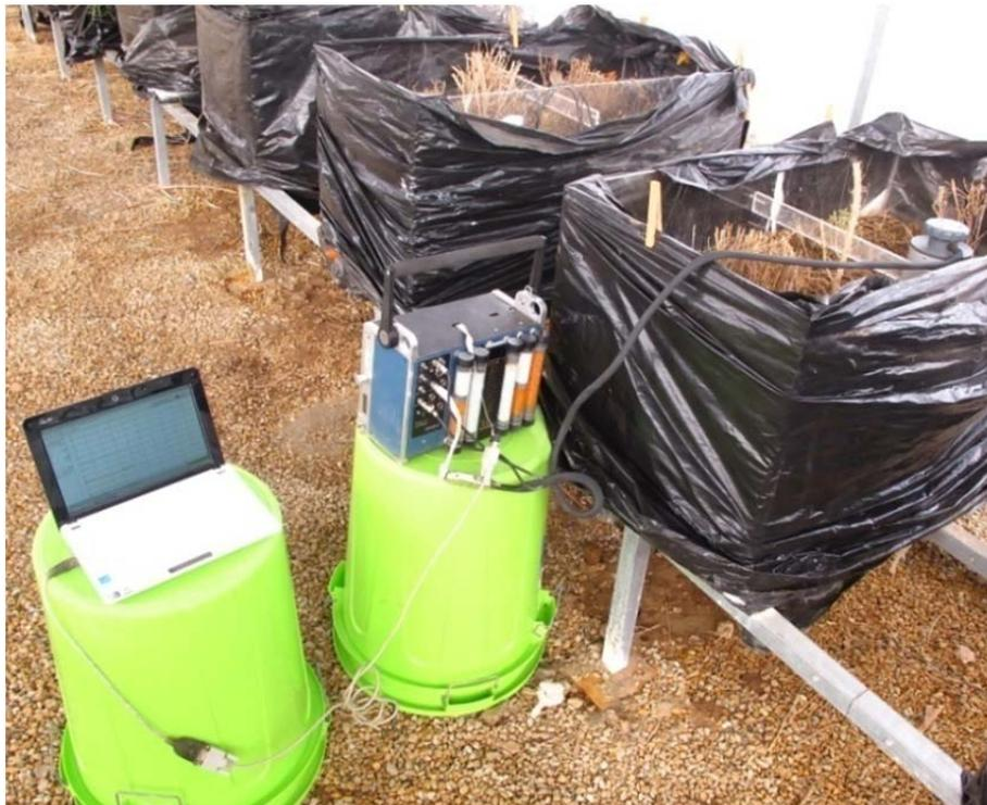
Fotografía 4.9. Equipo CIRAS-2 (sobre bidón verde) unido mediante interfaz al PC-portátil para el almacenamiento de datos y cubeta SRC-1 acoplada al anillo insertado en el suelo del mesocosmo para la medición *in situ* del dióxido de carbono (CO<sub>2</sub>) emanado desde el suelo.
