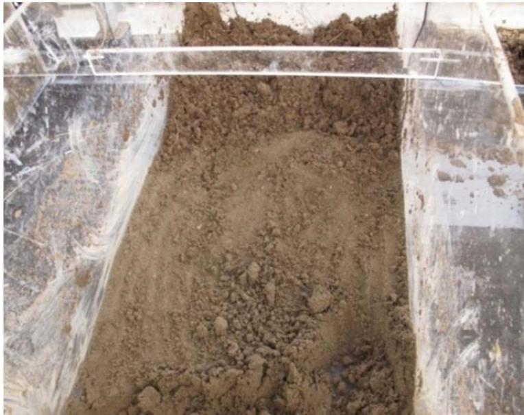
Fotografía 4.3. Detalle del lecho de arena (horizonte subsuperficial) en uno de los mesocosmos.
