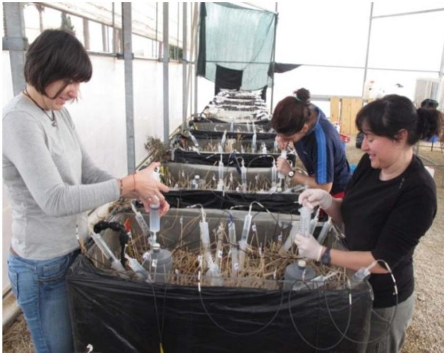
Fotografía 4.14. Removiendo el aire del interior de las cámaras para homogenizar la atmósfera tras la inyección del acetileno ( $C_2H_2$ ).
