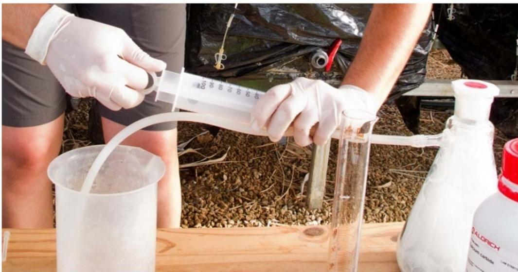
Fotografía 4.12. Producción y extracción del acetileno ( $C_2H_2$ ) para su inyección en las cámaras de muestreo.
