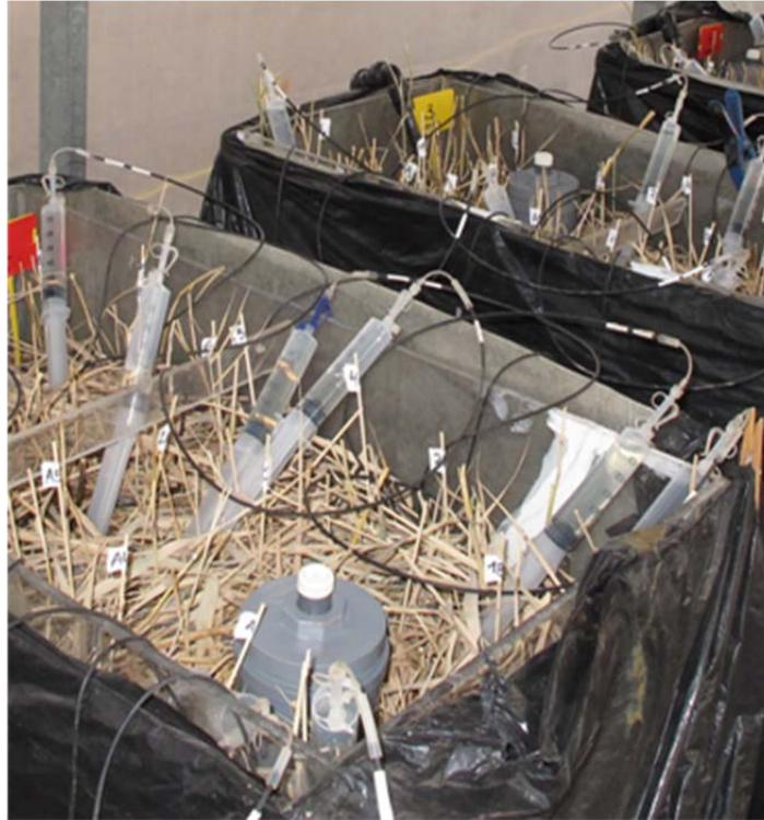
Fotografía 4.6. Jeringas de succión de 50 mL acopladas a los tubos de extensión de polietileno que las conectaban con los muestreadores Rhizon®, que se encontraban enterrados, para extraer el agua de poro del suelo.
