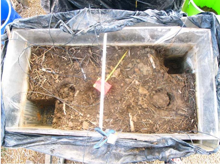
Fotografía 4.15. Extracción de bloques de suelo de los mesocosmos para la determinación del volumen, cuantificación de raíces y rizomas de *Phragmites australis* y análisis de las muestras.
