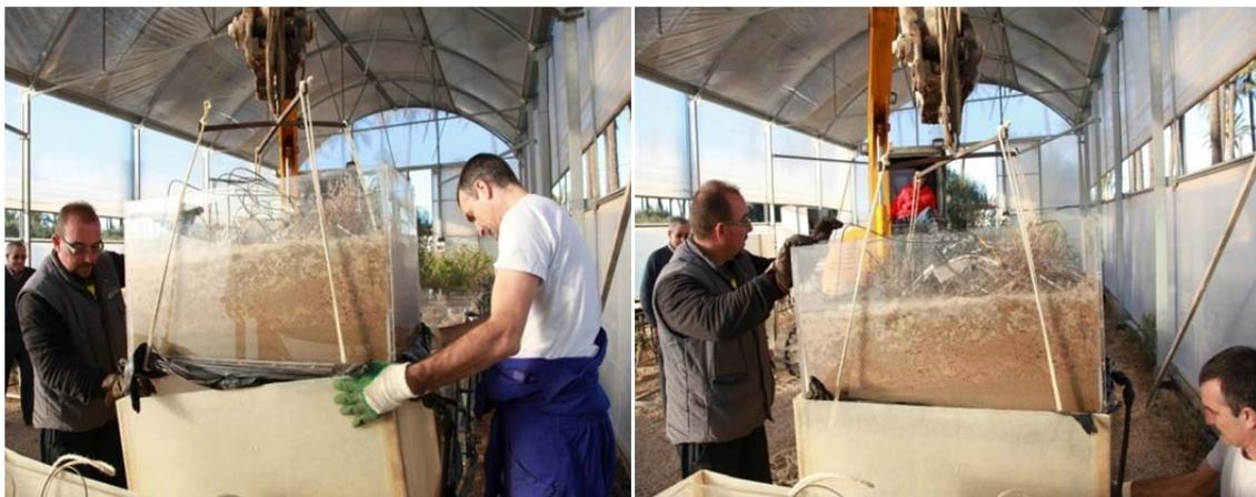
Fotografía 4.4. Introduciendo los mesocosmos en depósitos estancos de poliéster reforzados con fibra de vidrio (PRFV).
