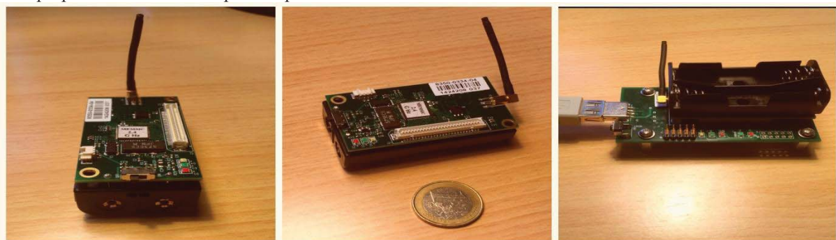
Fig. 1. Mote Micaz empleado en el estudio.
