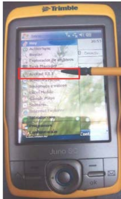
Figura 15. Dispositivo GPS Trimble Juno SC PDA utilizado realizar fotos georreferenciadas en coordenadas UTM.
