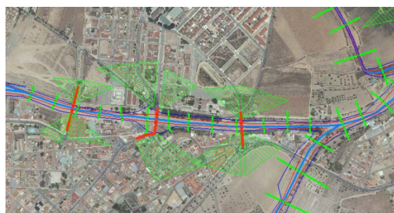
Fig. 1. Secciones transversales consideradas en HEC-GeoRAS para el estudio de la Rambla del Albuñón a su paso por el municipio de Fuente Álamo.
