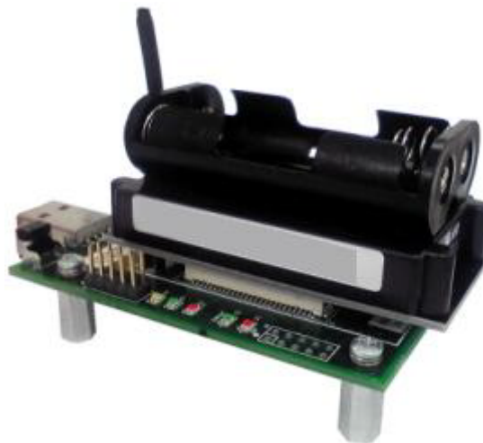
Figura 2.9 Dispositivo MICAz acoplado a una placa de conexión MIB520
