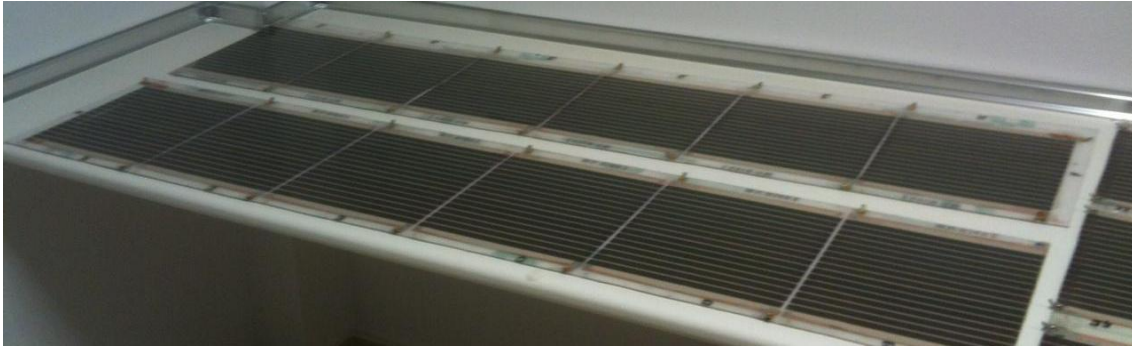
Figura 6.3 Panel orgánico fotovoltaico utilizado en el sistema
