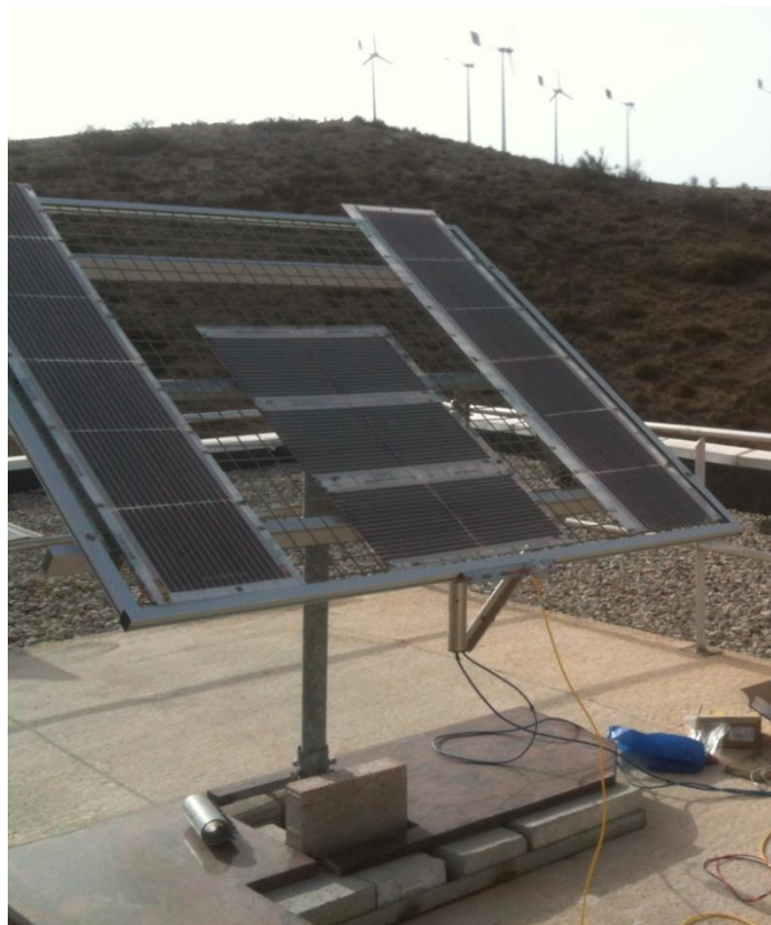
Figura 6.20 Seguidor solar con módulos solares orgánicos
