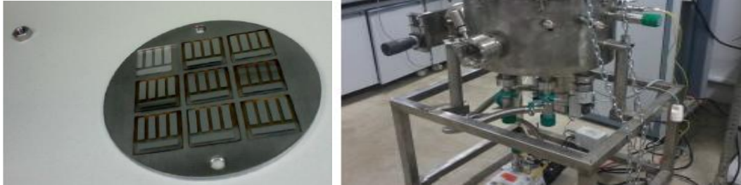
Figura 5.1 Mascara de contactos izquierda y cámara de vacío derecha
