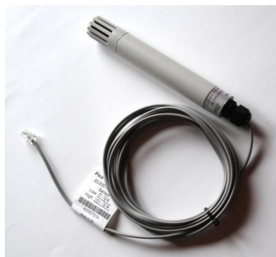
Figura 6.10 Sensor de humedad y temperatura
