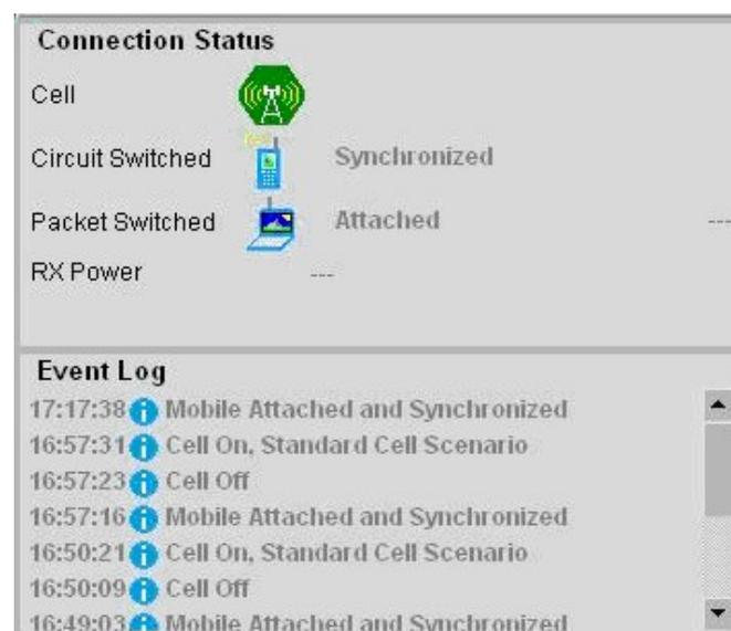
Figura 6.6. Ejemplo de un dispositivo móvil unido a la red GSM.
