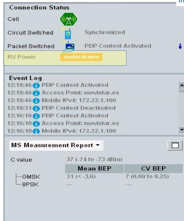
Figura A.2. Nivel de señal recibida en el R&S CMW500 insuficiente.
