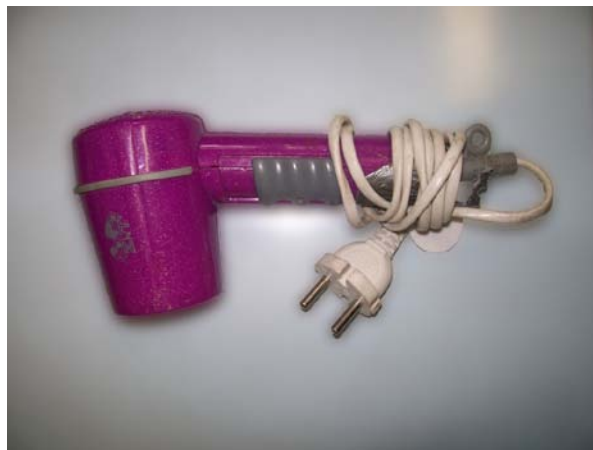
Figura 3.23 Secador de mano empleado para eliminar la condensación
