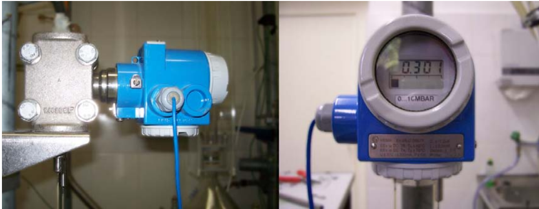
Figura 3.2 Manómetro diferencial digital (ENDRESS & Hauser, Deltabar S PMD235)
