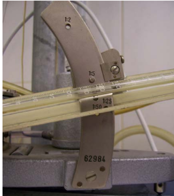
Figura 3.36 Detalle del factor de escala en manómetro de tubo inclinado
