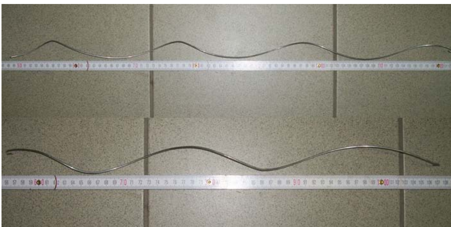
Figura 3.31 Muelle 5 (arriba) y 6 (abajo) paso 210 mm
