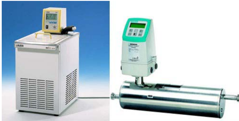
Figura 3.9 Termostato (Lauda RE210 + E200) y caudalímetro (MASS 6000 IP67 + MASS 2100 D16)
