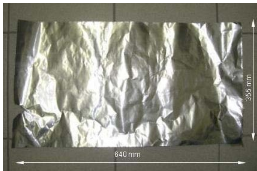
Figura 3.21 Anti salpicaduras para el termostato de refrigeración
