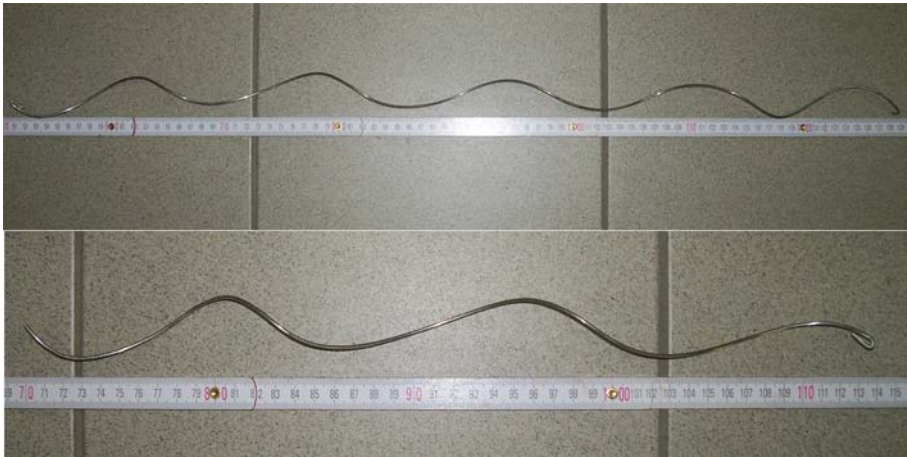
Figura 3.30 Muelle 3 (arriba) y 4 (abajo) paso 160 mm
