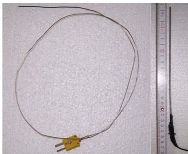
Figura 3.10 Termopar con cable de extensión y conector (izq.) y resistencia de platino PT-100
