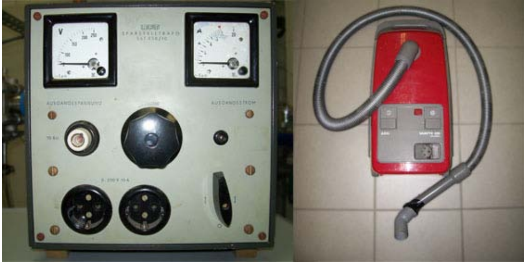
Figura 3.5 RFT Sparstelltrafo SST 250/10 + aspiradora
