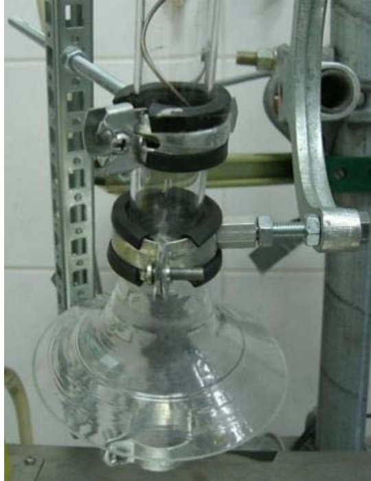
Figura 3.20 Tobera de descarga en la parte inferior del tubo
