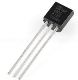
*Ilustración 3.23. Vista del sensor analógico TMP36GZ*
