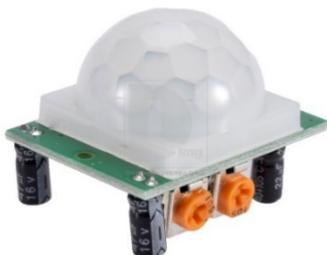
***Ilustración 3.27. Vista del sensor PIR HC-SR501***
