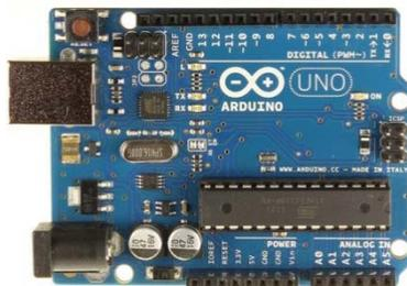
*Ilustración 3.11. Vista Conjunta Arduino UNO*
