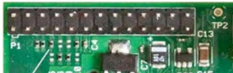
Ilustración 3.18. Vista del GPIO de Raspberry Pi modelo B
