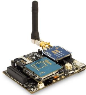
*Ilustración 2.6. Vista de la placa Waspote.*
