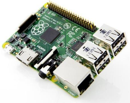
*Ilustración 2.4. Vista Raspberry Pi modelo B+.*
