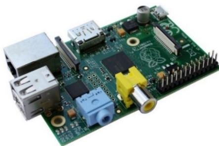
*Ilustración 3.17. Vista de la Raspberry Pi modelo B*
