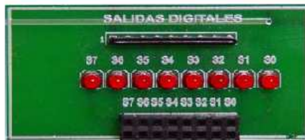
Figura 6.4 Salidas digitales incorporadas en Picschool.
