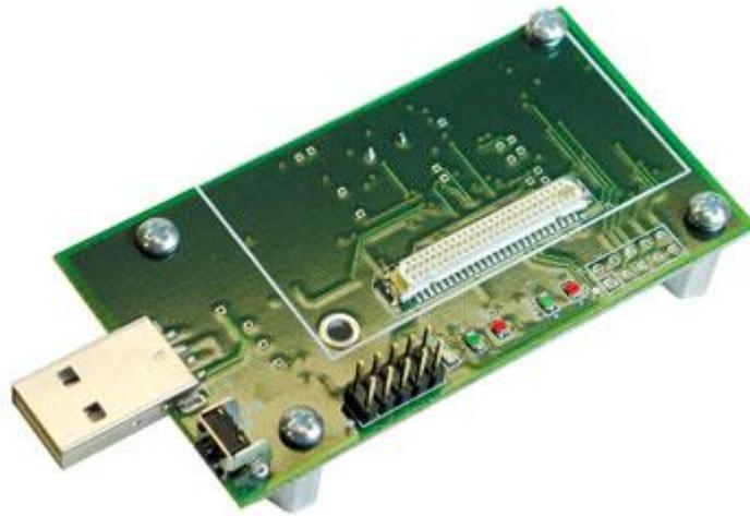
Figura 3.15: Placa programadora MIB520
