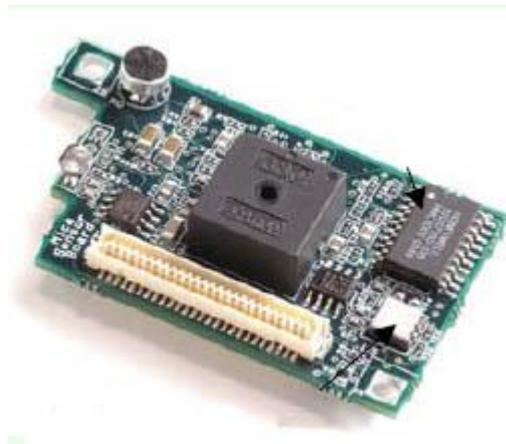
Figura 3.14: Placa sensora MTS310CB
