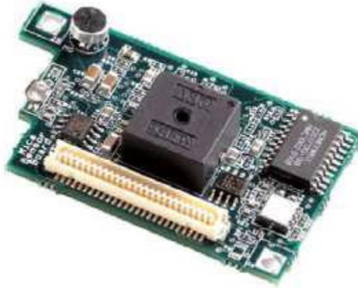
Figura 3.2: Placa sensora de para mote MicaZ.
