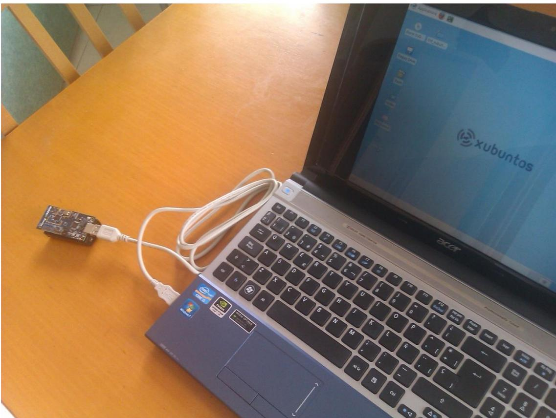
Figura 5.2: Nodo Moteiv Tmote Sky funcionando como puerta de enlace en alguna de las pruebas realizadas.
