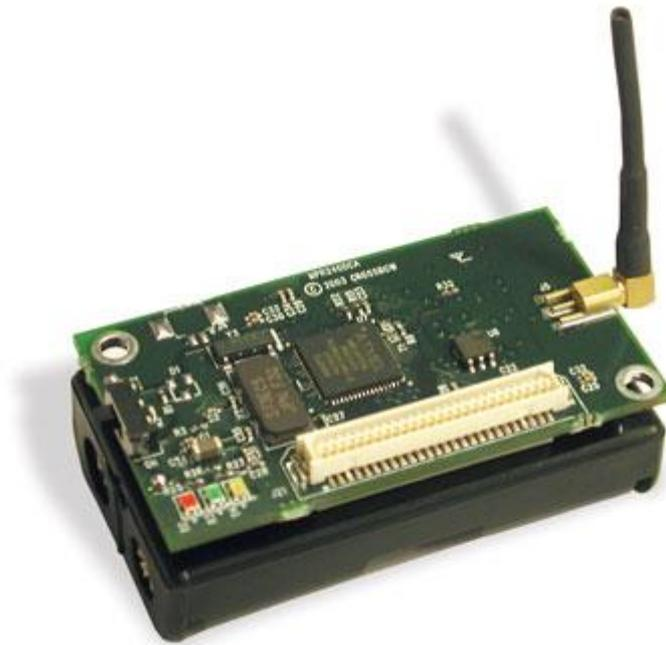
Figura 3.13: Nodo sensor MicaZ
