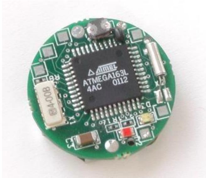
Figura 3.10: Nodo sensor Mica2Dot
