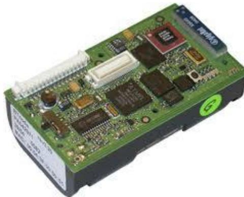
Figura 3.5: Nodo sensor BTNode3
