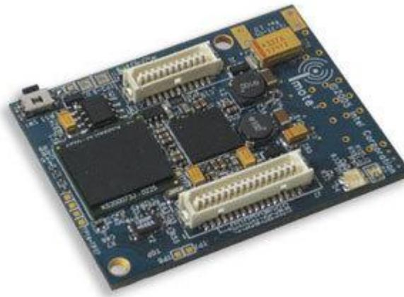
Figura 3.7: Nodo sensor Imote2
