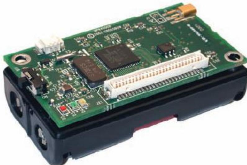
Figura 3.9: Nodo sensor Mica2
