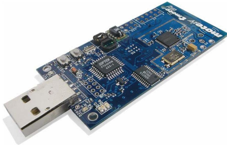
Figura 3.16: Modelo similar a TelosB usado en el desarrollo de la aplicación, el moteiv tmote sky.
