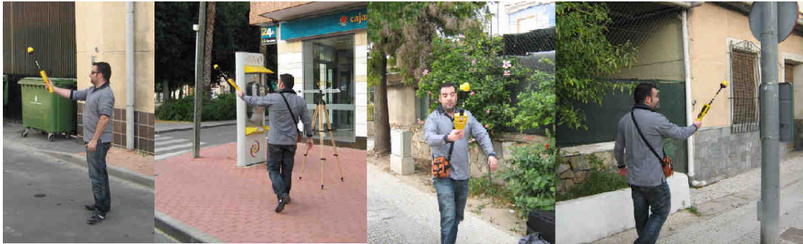
Figura 19. Localización de puntos de máximo nivel de campo.
