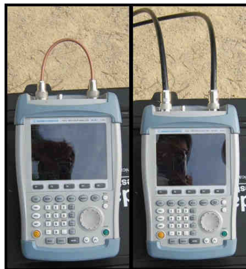
Figura 17. Puesta a cero del analizador de espectro (izquierda) y cálculo de pérdidas del cable (derecha).
