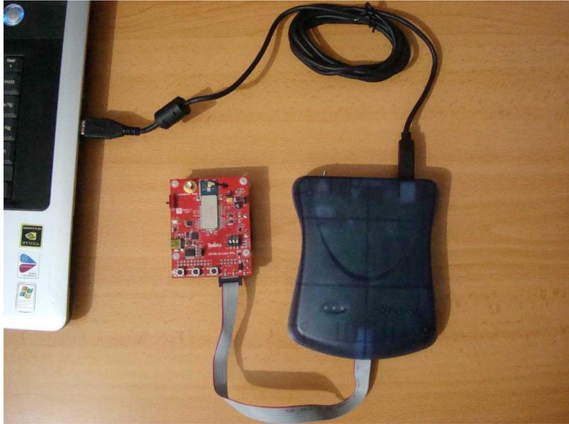
**Fig 4.8** Conexión del programador
