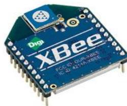
**Fig 2.24** Módulo XBee
