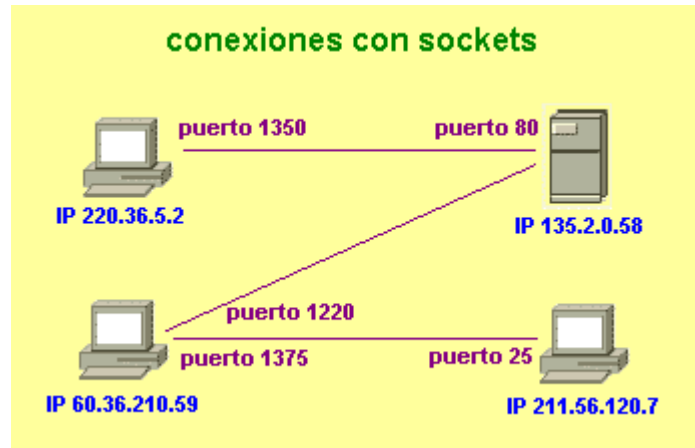
Figura 7.2 Ejemplo de conexión entre sockets
