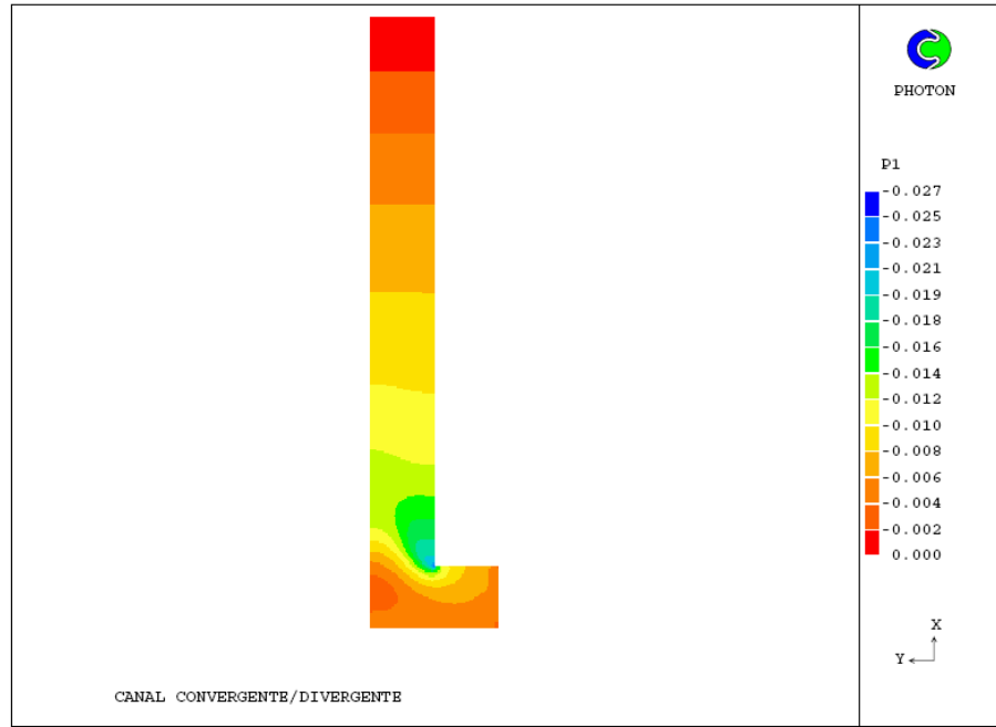
Figura 6.27. Distribución de presiones en una chimenea solar con condición de flujo de calor simétrico en sus paredes verticales, un número de Rayleigh de 10^9 y relación de aspecto b/L igual a 0.1.
