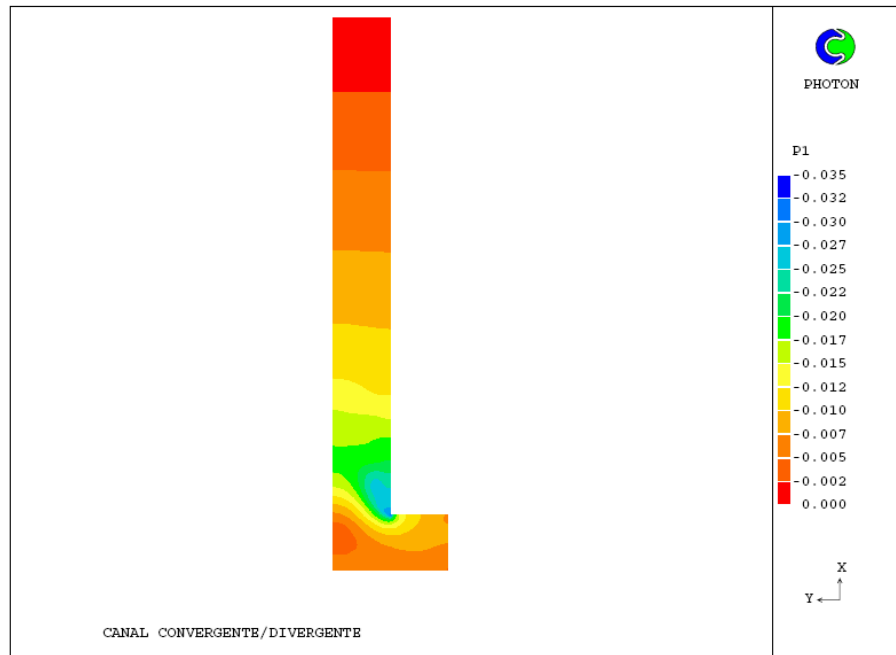
Figura 6.28. Distribución de presiones en una chimenea solar con condición de flujo de calor simétrico en sus paredes verticales, un número de Rayleigh de 10^{10} y relación de aspecto b/L igual a 0.1.
