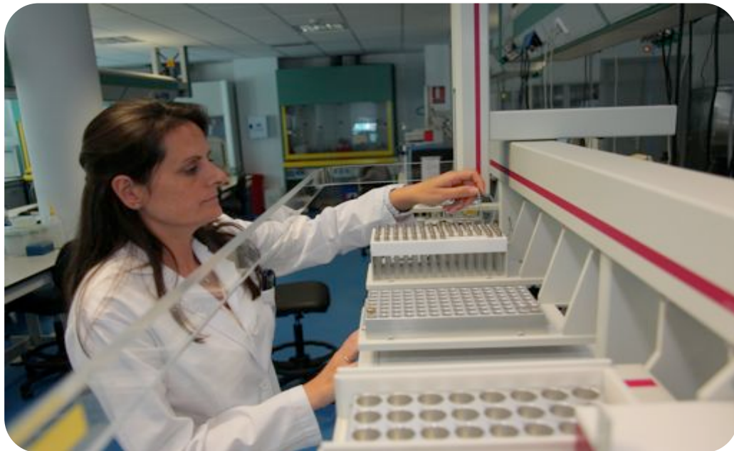
María José Roca coloca la muestra en el lugar desde el que se introducirá al interior del cromatógrafo
