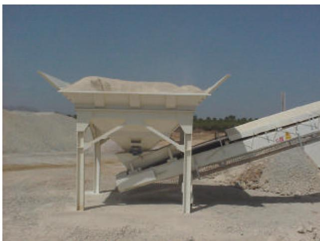
Figura 3.- Fotografía en la que se muestra la quinta tolva acoplada a la planta mediante la cinta transportadora.
