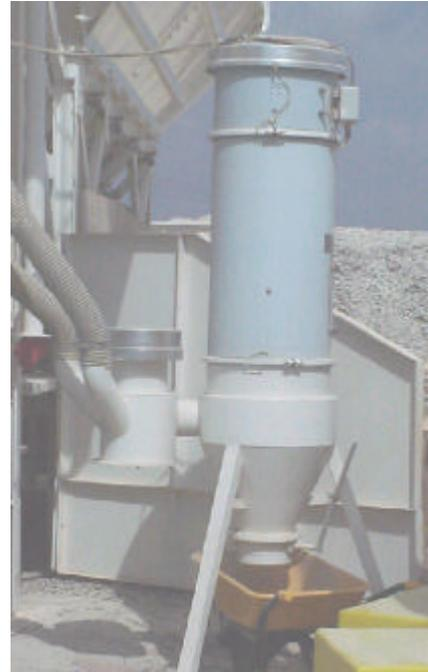
Figura 13.- A la derecha se muestra el sistema de inyección de cemento utilizado para el acopio del mismo.
