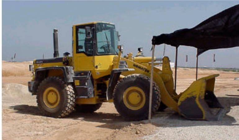
Figura 6.- Cargadora *Komatsu* WA-270, con la que se realiza la carga de áridos en las tolvas.
