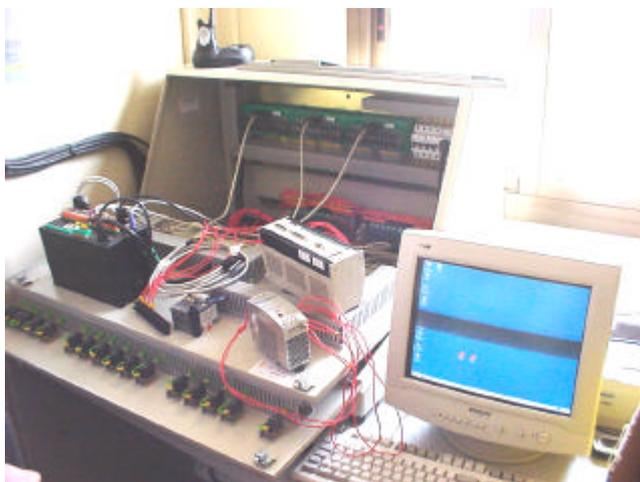
Figura 20.- En esta fotografía se muestra como se cambia el controlador Cantabria por el InfoDina, que se ubica en el tablero de mando.
