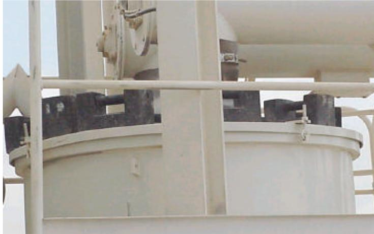
Figura 21.-Báscula de cemento cargada con las 10 pesas de 20 Kg; 200Kg en total.
