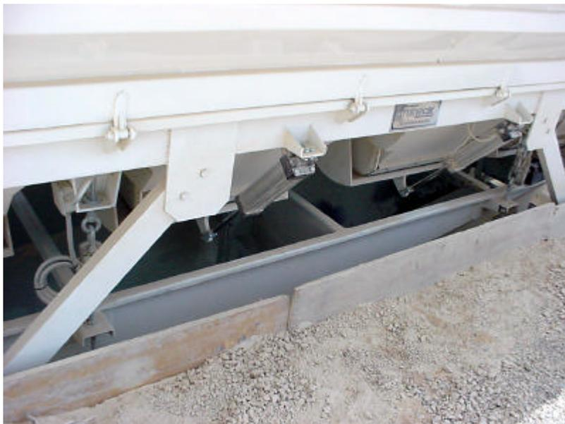
Figura 14.- Báscula de pesaje de áridos a la cual caen todos los áridos a traves de las bocas de la tolva (dos bocas por tolva), excepto la tolva de árido 5 que vierte el árido gracias a una cinta transportadora.
