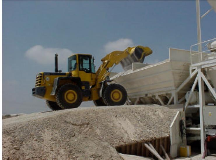
Figura 11.- En esta fotografía se muestra como se cargan las tolvas con la pala cargadora.
