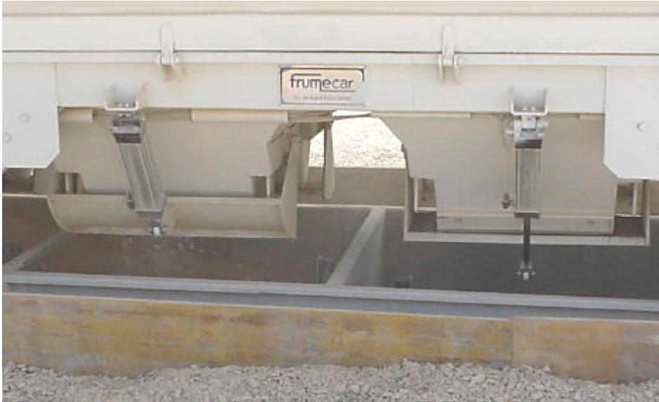
Figura 23.- En el proceso de reapertura rápida, los pistones neumáticos de las bocas de las tolvas se abren y cierran repetida y rápidamente. En la figura se puede contemplar como mientras la boca de la izquierda está en fase de apertura la de la derecha esta cerrada.
