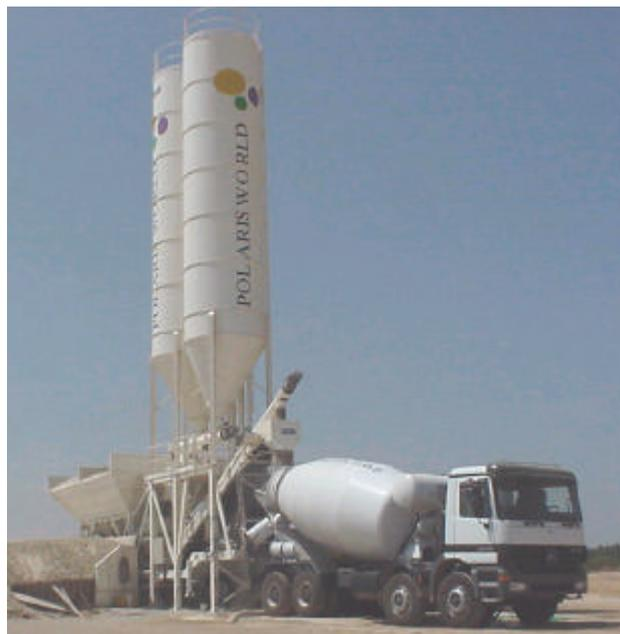
Figura 2.- Fotografía de la central de hormigón móvil utilizada en la planta de *Mar Menor Golf Resort* de *Polaris World*.
