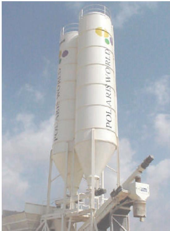
Figura 12.- En la fotografía de la izquierda se distinguen los dos silos de cemento de la planta.
