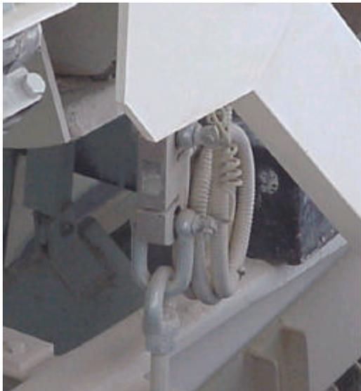
Figura 15.- Báscula de áridos en la que se puede ver las células pesaje de uno de los laterales.
