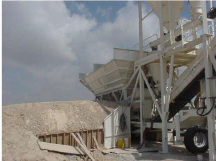
Figura 4.- Rampa de carga para facilitar la carga de las tolvas.
