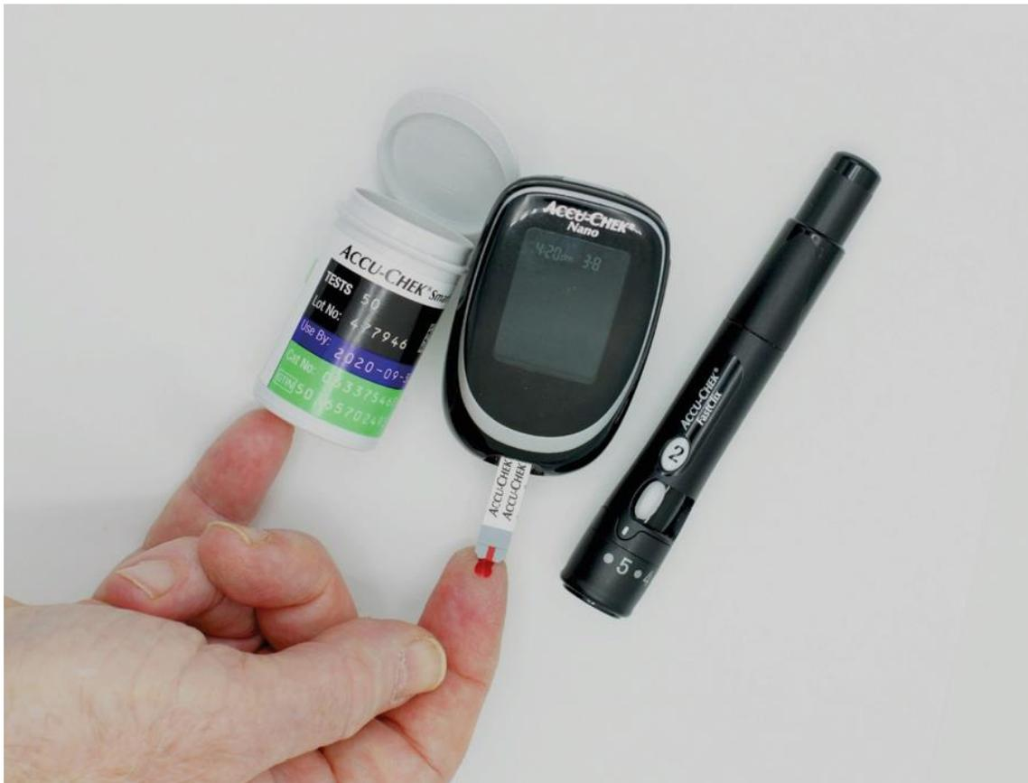
*Figura 29: Medidor de glucosa en sangre. Este equipo de medición es un biosensor específico para medir el nivel de glucosa en sangre y es muy útil para los enfermos diabéticos, quienes, al conocer sus valores de glucosa, pueden establecer un control seguro de la enfermedad.[64]*
