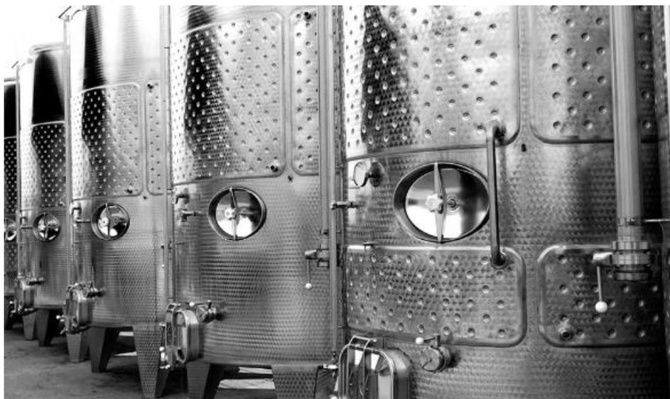
*Ilustración 13. Tanques para desfangado y fermentación alcohólica*
