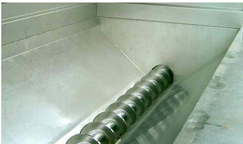
*Ilustración 10. Tolva de recepción con tornillo sinfin*
