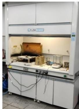
**Figura 13.** Campana FlowTronic con placa calefactora.
