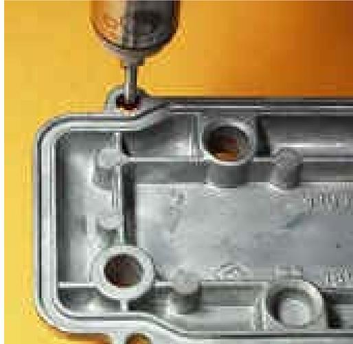
Figura 2.8.- Palpador activo con sensor digital
