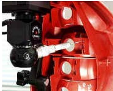
Figura 2.11.- Facilidades de acceso con SAP multiposición motorizado
