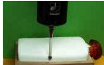
Figura 2.15.- Digitalizado con SAP de contacto continuo
